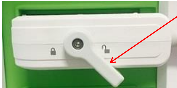
Figura 30: Manopola di bloccaggio sul connettore del trasduttore sbloccata
